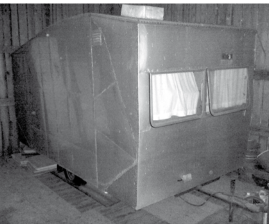
Nutid. Här ser man den uträttade tak och golvlinjen, vilket innebär betydligt större utrymmen inne i vagnen
