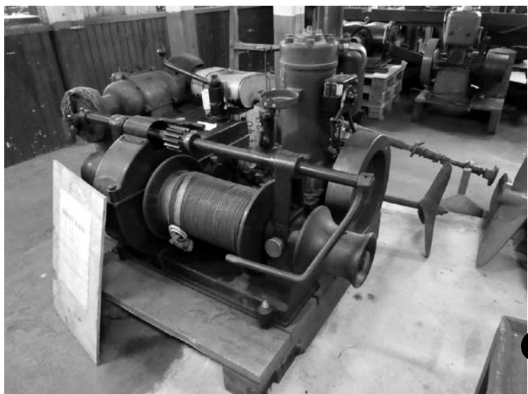
Drott motorvinsch 8 hk. tillverkad 1935
