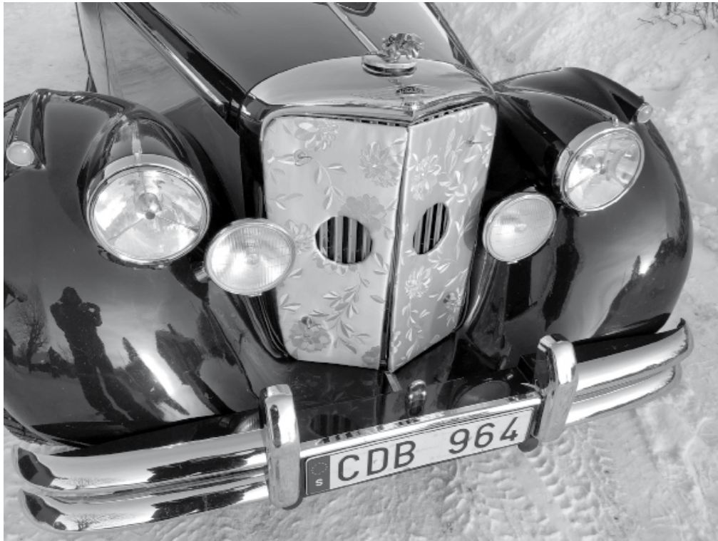
Ett försök att få värme i motorutrymmet
